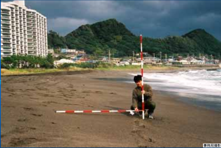
写真 - 44 同上:粗粒砂から成る急勾配のバーム
