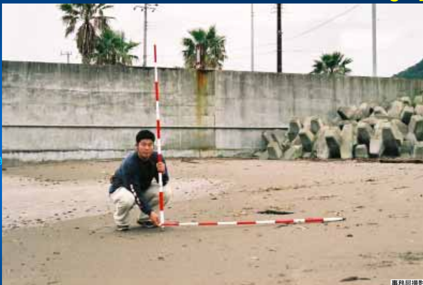
写真 - 13 同上: 鴨川漁港防波堤隣接部の海浜: 細粒砂から成る非常に緩勾配の前浜 (バーム高の低い平坦な浜)
