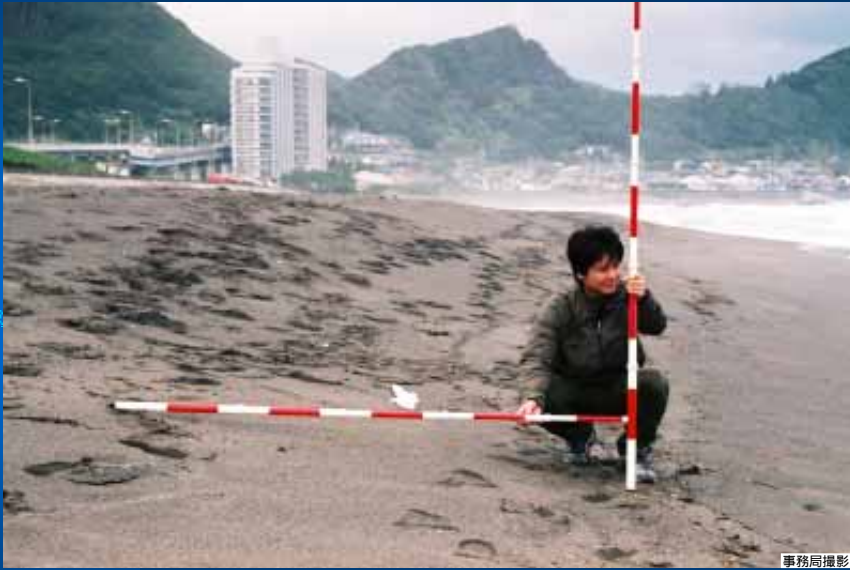
写真-40 同上:粗粒砂から成る急勾配の前浜と波の打ち上げで堆積してできた標高の高いバーム
