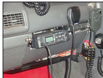
消防用無線受令機
