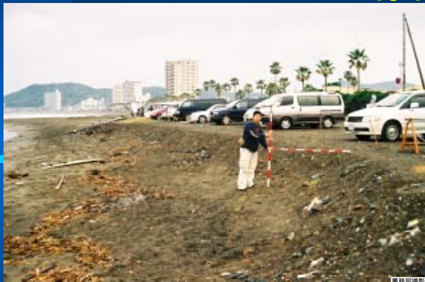
写真?18 待崎川河口右岸導流堤の右岸隣接部の後浜から前出して 造成された駐車場前で見られた浜崖侵食
