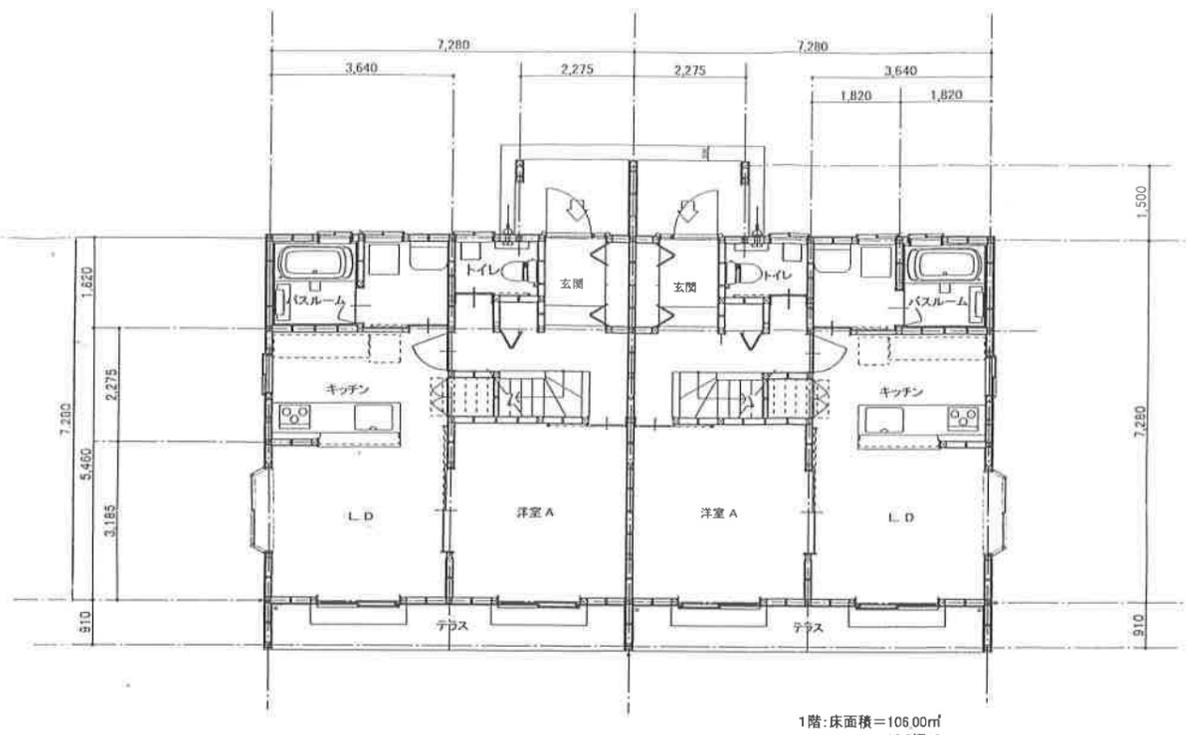
B棟 一階平面図 S=1/100
