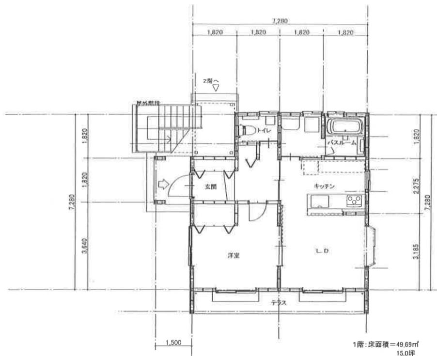
A棟 一階平面図 S=1/100
