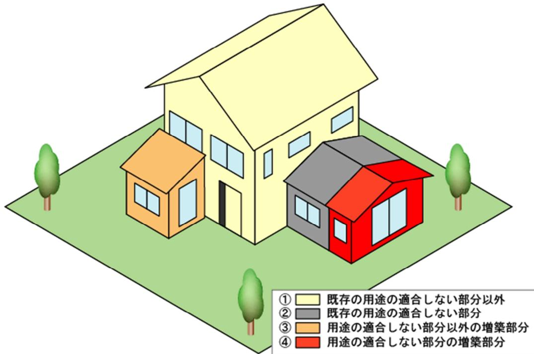
$$\frac{(①\text{の床面積}+②\text{の床面積}+③\text{の床面積}+④\text{の床面積})}{(①\text{の床面積}+②\text{の床面積})} \leq 1.2$$
